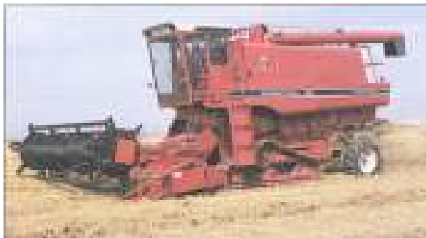
IH 1480 Rice Special (speciel udrustet "ris-maskine"), kunne monteres med IH designede og fremstillede larvefodder/bælter.
