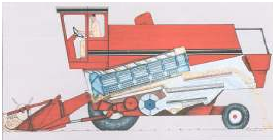
Et skridt fremad og to tilbage. Materiale indtaget er nederst i rotor huset, indføringskanalen er kort, som vist på denne tværsnitstegning, var et væsentligt fremskridt i den afsluttende design fase af IH Axial-Flow maskinen. Den vibrerende plade til halmudkastet og det brede bælte transportør under rotoren var begge tilbageskridt.
