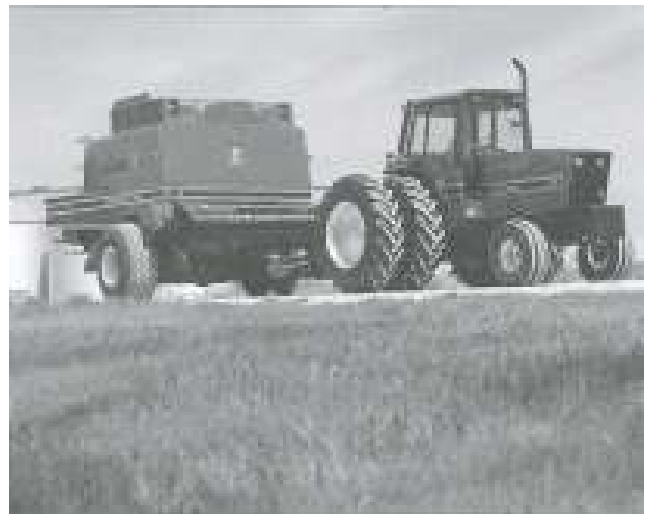
Udrustet med en 8900 liters korntank og 76 cm. Diameter rotor krævede den bugserede IH 1482 Axial Flow mejetærsker mindst 130 hk på kraftudtaget ved 1000 rpm. Hele maskinens drivlinje var designet til en ydelse på op til 200 hk. En 3,4 m pick up kunne monteres på de 12,5 fods skærebord til skårlagte afgrøder. Til nogle opgaver kunne der leveres en skærebord på 17,5 fod.
